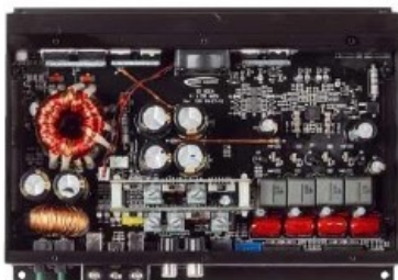
Die verstärkenden Halbleiter sitzen typisch unter der Platine, von oben ist rechts unten nur die Ausgangsfilterung mit Spulen und Kondensatoren zu sehen
